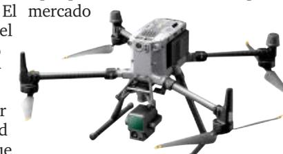
Los drones pueden cargar hasta 30 kilos de peso y sostienen tener 3 horas de vuelo.
