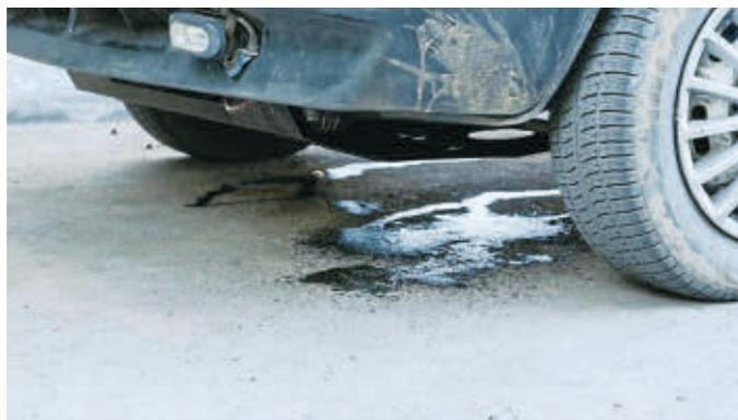
El sobrecalentamiento del motor puede hacer que los sellos y juntas se deterioren más rápidamente, lo que aumenta el riesgo de fugas de aceite.
