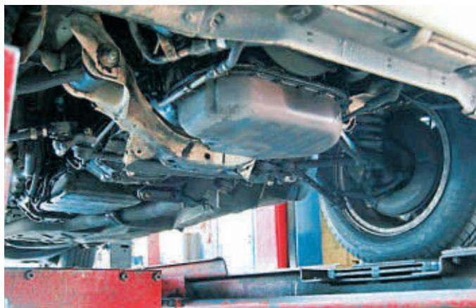
Es importante realizar un mantenimiento regular del sistema de lubricación del carro, incluyendo cambios de aceite programados, inspecciones visuales del cárter y la junta, y reemplazo de componentes desgastados o dañados.
