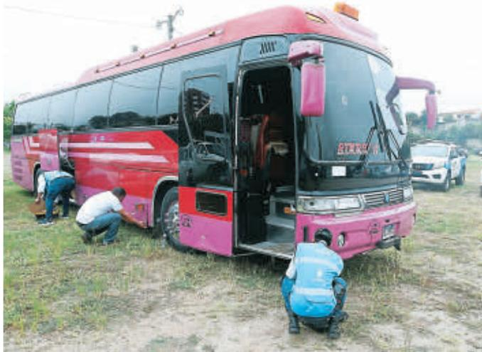
El personal técnico inspecciona la parte mecánica, eléctrica, sistema de dirección y otros factores de cada uno de los buses.
